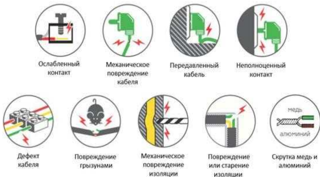
Рисунок 6. Возможные причины искрения в электропроводке
