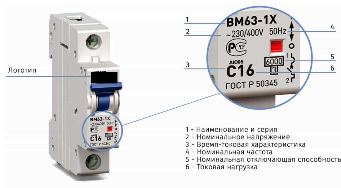
Рисунок 2. Пример маркировки АВ
